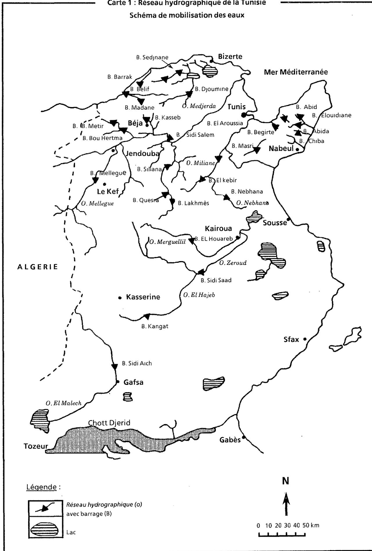
Quatre barrages moyens ont été construits de 1959 à 1966 et sont destinés exclusivement à l'irrigation. Enfin, deux autres grands barrages, Kasseb et Bir M'Cherga fournissent respectivement 40 Mm<sup>3</sup> d'eau potable et 25 Mm<sup>3</sup> d'eau d'irrigation tout en protégeant des inondations les plaines avoisinantes.
