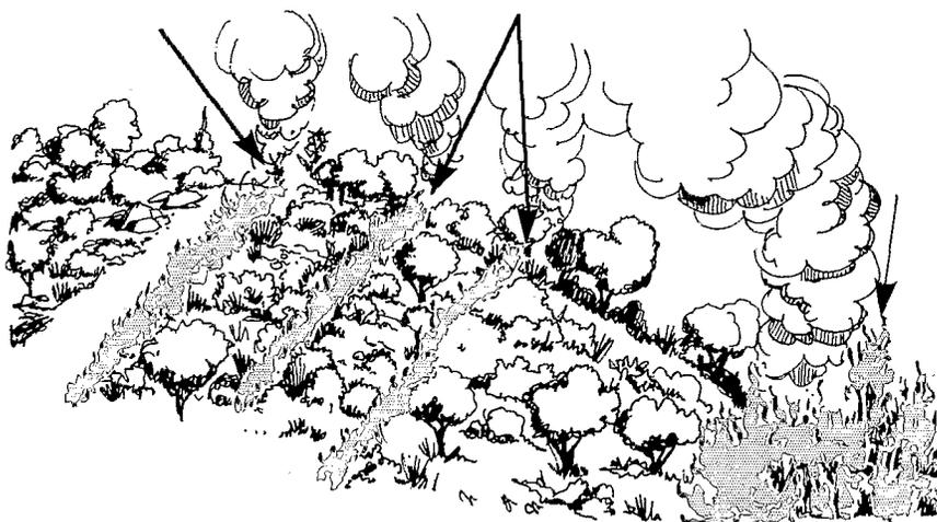
Fig. 3.10. Contre-feux auxiliaires. Le contre-feu, parfois, n'avance pas facilement vers l'incendie. On peut provoquer des brûlages auxiliaires pour attirer le contre-feu.
