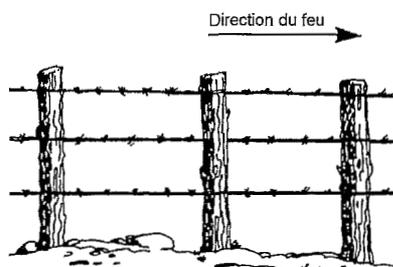
Fig. 2.14. Poteaux : du côté d'où souffle le vent, le bois est carbonisé et craquelé.
